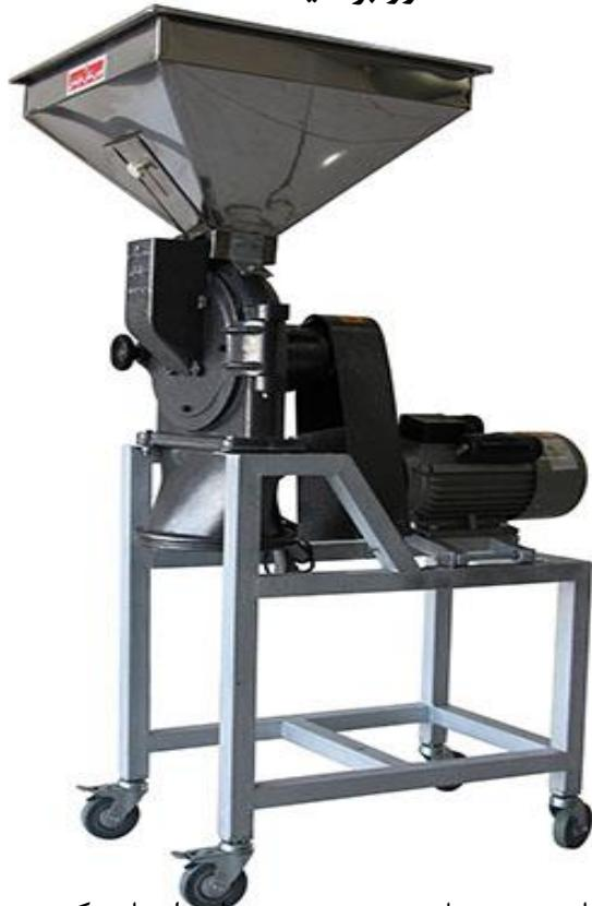
آسیاب مدل TS2700: آسیاب پین میل نیمه صنعتی برای آسیاب کردن مواد خشک و سخت استفاده می شود. طراحی آسیاب به حالتی می باشد که مواد در داخل آسیاب بین پین ها و دنده ها کوبیده می شود و از توری هایی که مش بندی متفاوتی دارند عبور میکند و به کیسه ای که زیرخروجی قرار دارد ریزش پیدا می کند. مکانیزم خاصی که این آسیاب دارد قادر به پودر کردن مواد چرب نیست و فقط مواد خشک را به پودر یکدستی تبدیل میکند.
